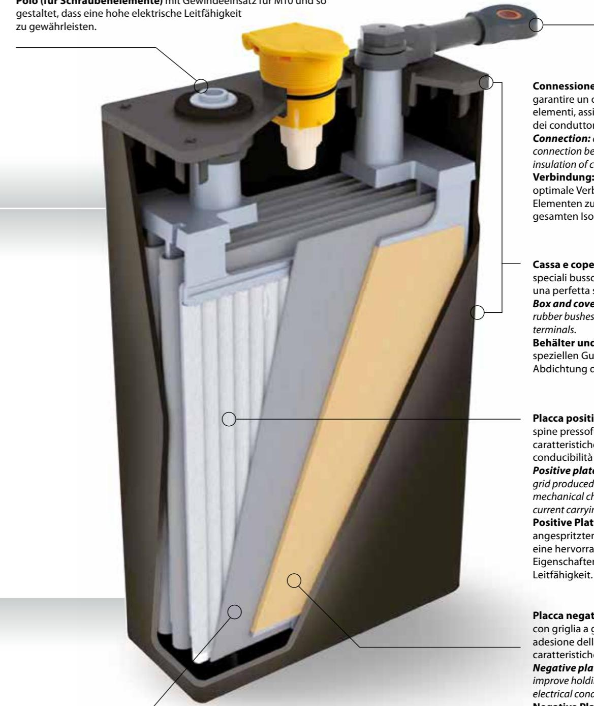
**Separatore:** manica in polietilene microporoso, garantisce totale isolamento tra placche positive e negative.
